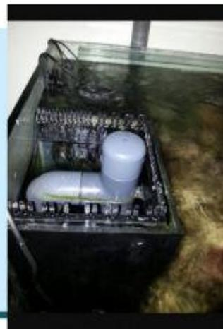
dans un compartiment appelé "surverse" ou encore un "Déversoir" constitué de 2 boîtes, une à l'intérieur, l'autre à l'extérieur du bac reliées par un siphon en forme de  $\cap$ . Cette entrée doit être munie d'un peigne afin d'éviter que les poissons y entrent.
